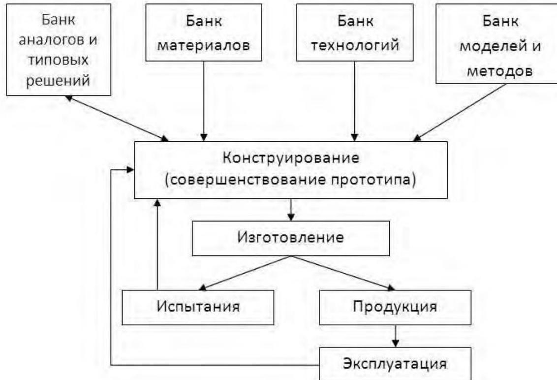
Кроме банка конструкций и комплексных решений используются банки материалов и технологий, а также банк информации об испытаниях и эксплуатации предшествующих исполнений, исследовании новых моделей.
