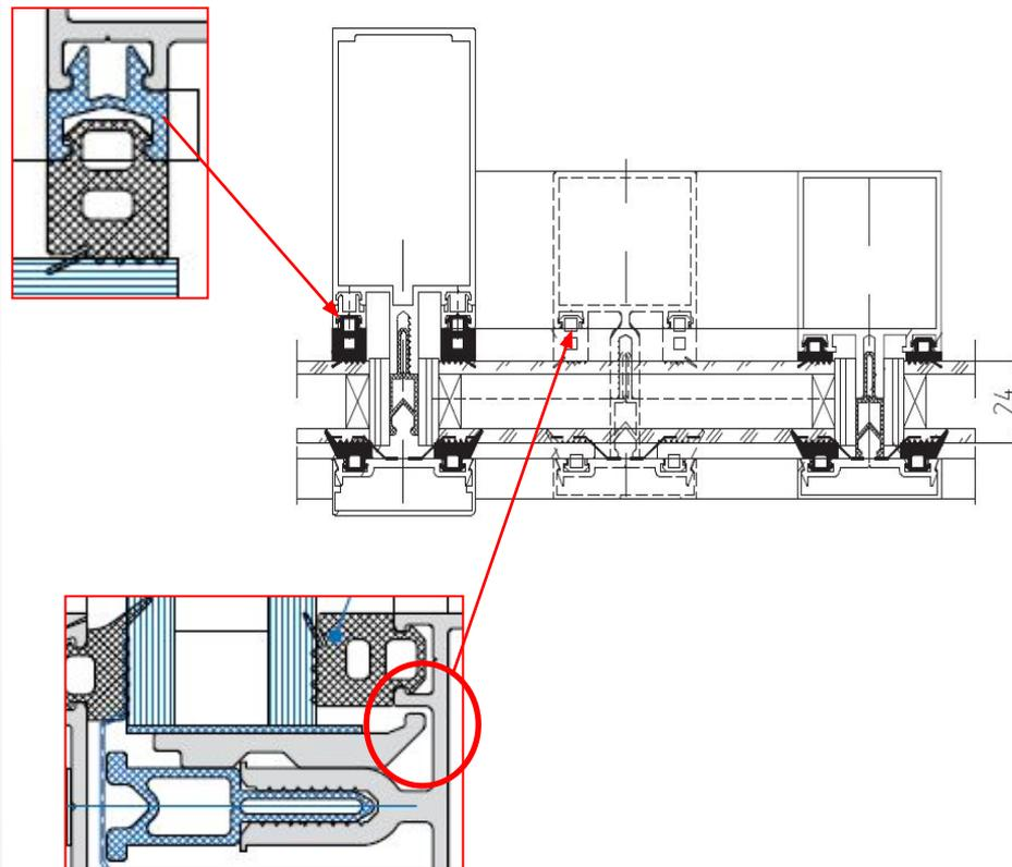
Многоуровневая стыковка реализуется при помощи стандартных стоек и ригелей. Однако, Необходим дополнительный адаптер; На стойке, используемой в качестве ригеля 2-го уровня, не фиксируется опорная подкладка.
