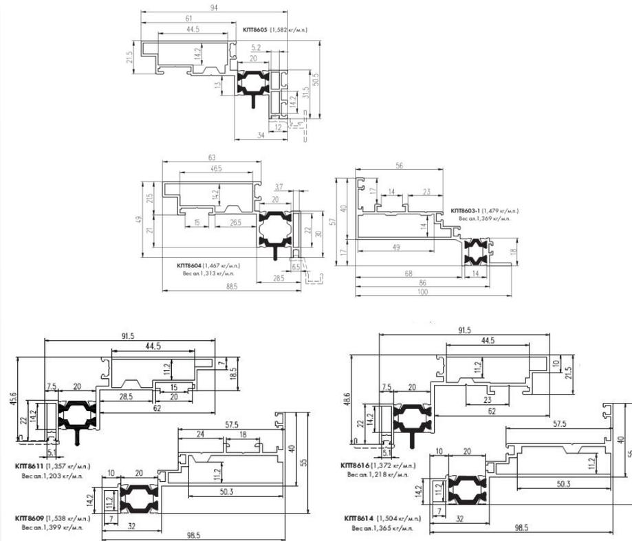
Номенклатура всего из 3-х основных позиций позволяет изготавливать «скрытую створку» для любых фасадов. Возможное заполнение 22-38 мм.
