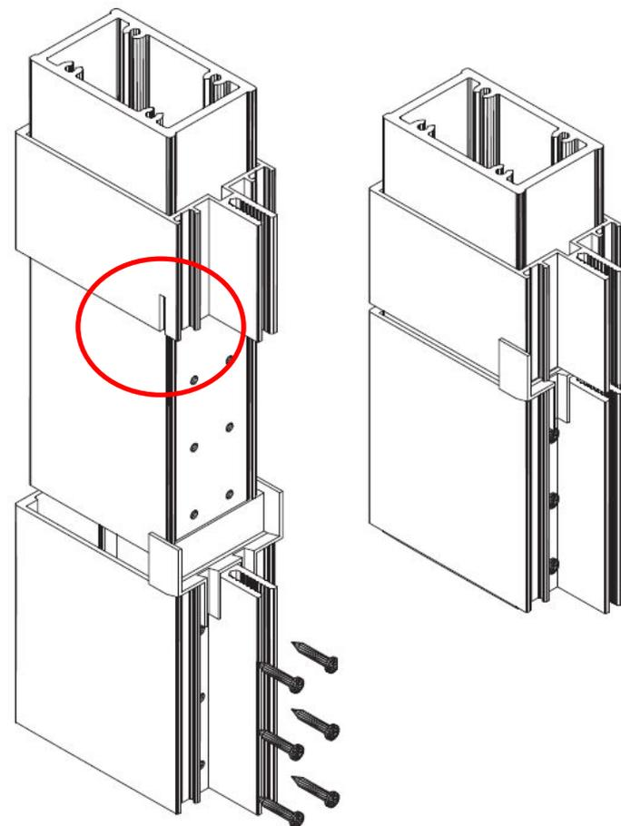
Чтобы обеспечить герметизацию и приемлемый вид место соединения стоек покрывается огромным количеством силикона.
