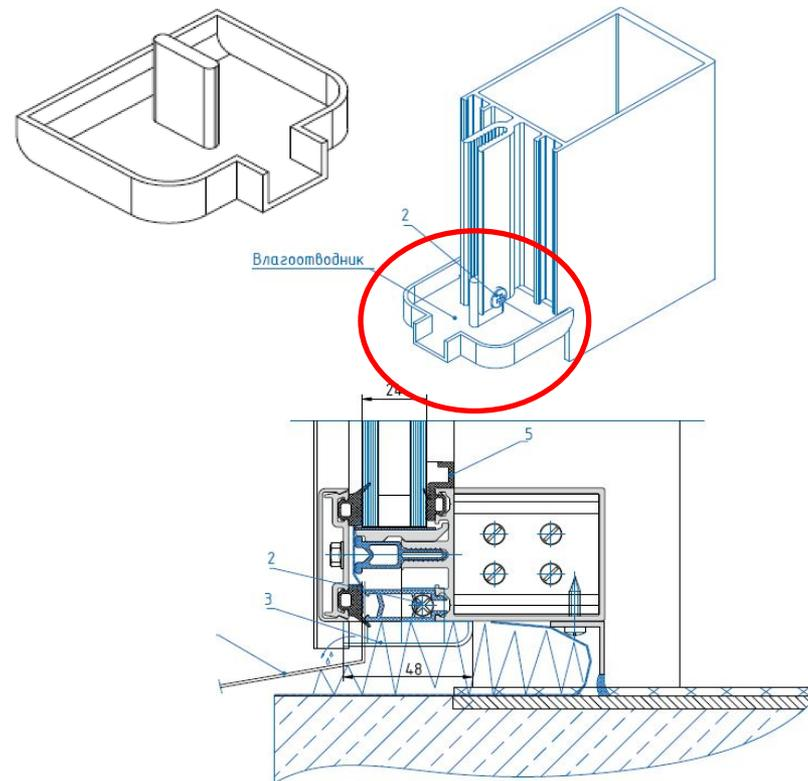
Для отвода влаги используется влагоотводник, который устанавливается внизу стойки, либо в местах соединения стоек.
