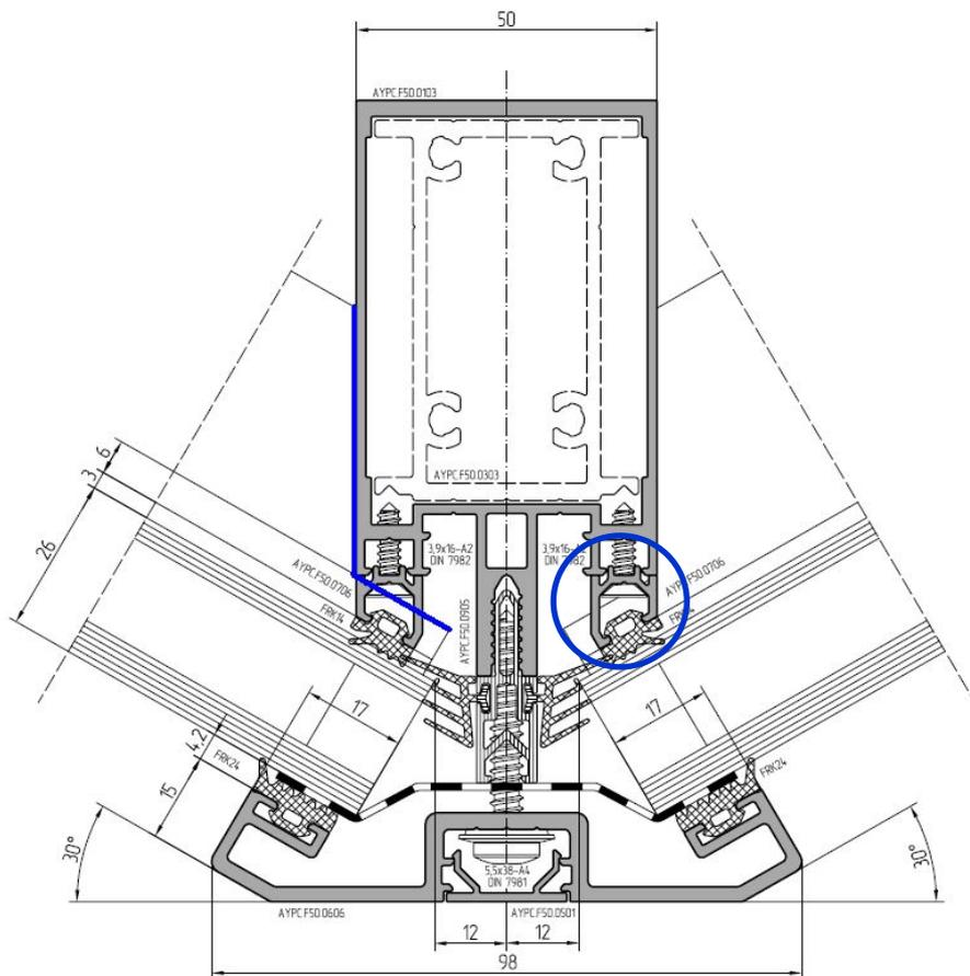
Излом фасада можно реализовать с помощью одной стойки и установленных на неё специальных профилей-адаптеров (15°-45°), имеющих разметочные линии для самореза.
