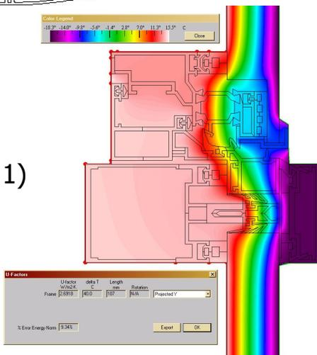
Применение и грамотная компоновка большого количества нетеплопроводных материалов позволяет достичь наивысшей степени теплоизоляции (!лучше чем у Шуко!)
