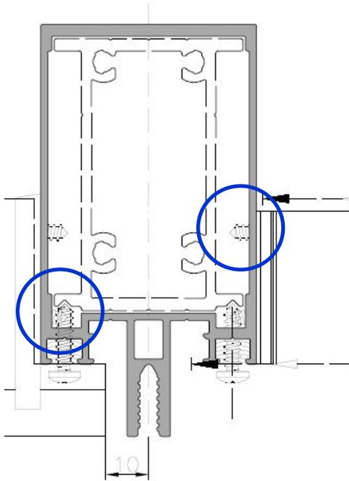
При изготовлении опор или закладной для разрыва стоек усиливающий профиль не нуждается в дополнительной обработке, т.к. саморезы фиксирующий сухарь и ригель не касаются закладного элемента
