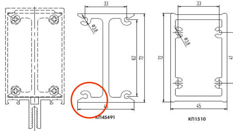
4-х саморезов  $\varnothing 4,2$  мм не достаточно для надежного крепления опорных пластин.
