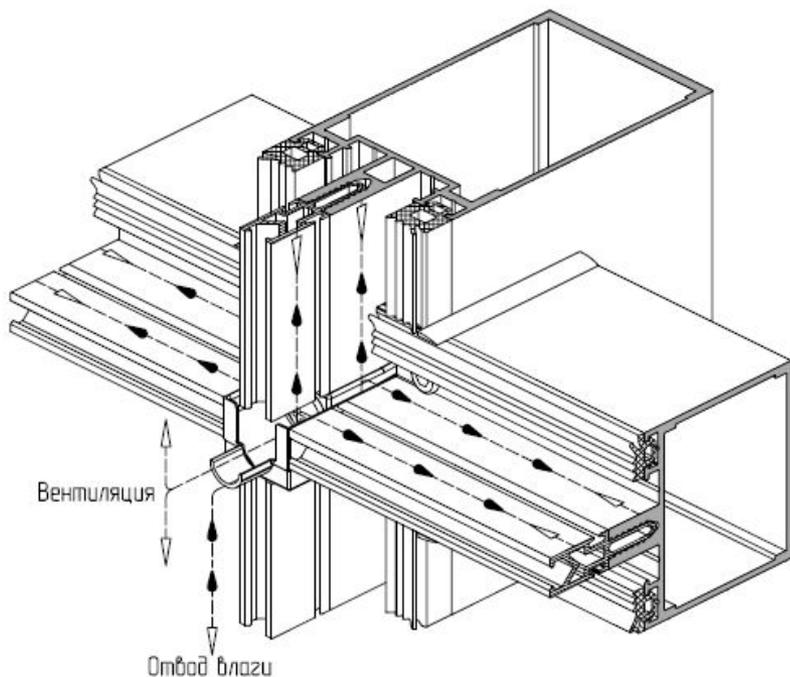
Полно проработаны вопросы отвода влаги из конструкции фасада наружу для всех толщин заполнений. В стоечные дренажные лотки через каждые 6-8 метров по высоте устанавливается капельник.
