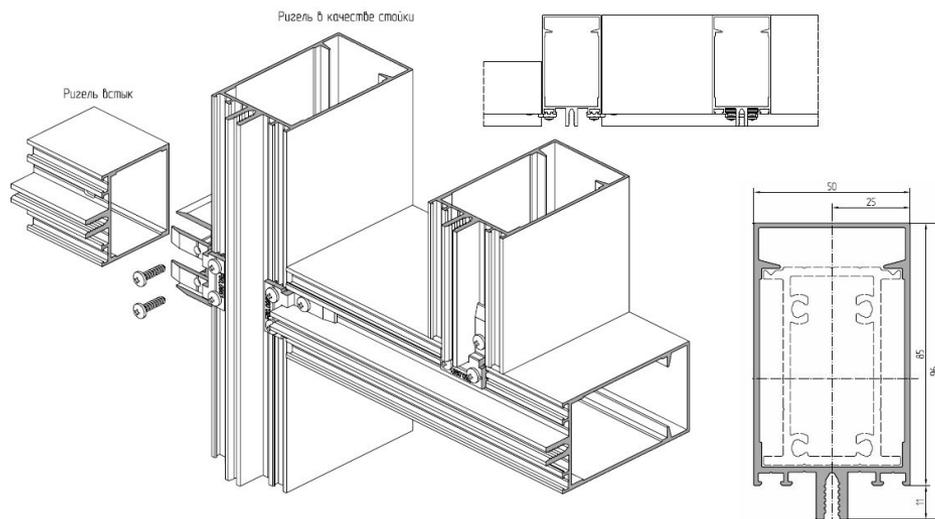
*При необходимости все ригели более 67 мм можно использовать в качестве стойки. Конфигурация их камер позволяет применять в качестве камерного соединителя стоечные усиливающие профили.*
