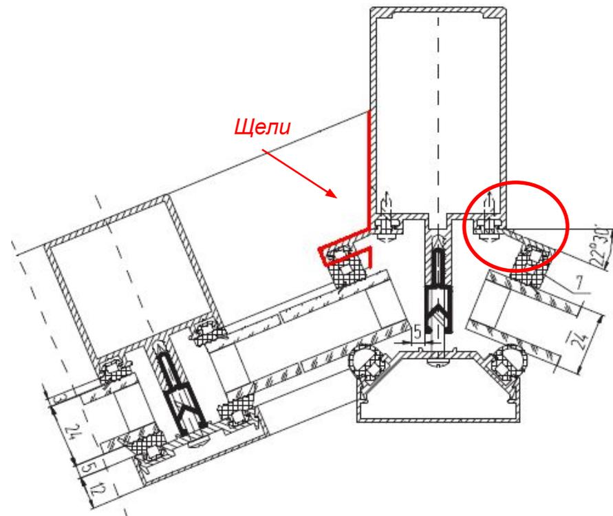
Излом фасада реализуется с помощью одной стойки и адаптеров (-30°, -45°).
