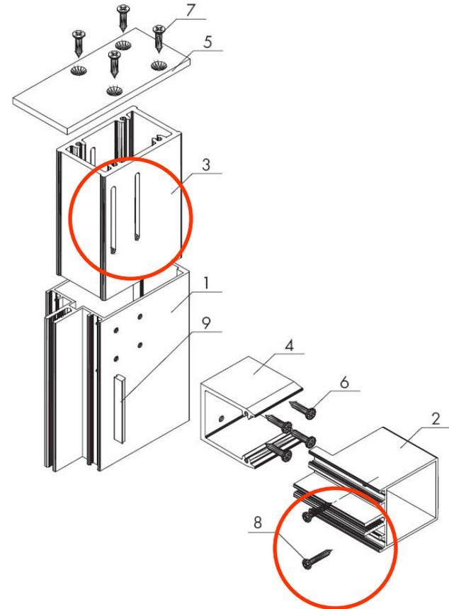
Для изготовления подвижных опор усиливающий профиль нуждается в дополнительной обработке. Ригель крепится не к стойке, а только к сухарю.
