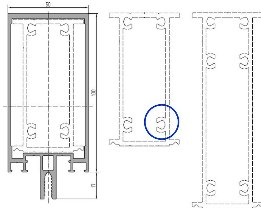
Отверстия в усиливающих (соединительных) профилях под саморезы  $\varnothing 5,5$  мм позволяет надежно закрепить опорные пластины. Для стоек 140 мм и более в усилители прикручиваются к пластинам 6 шурупами.
