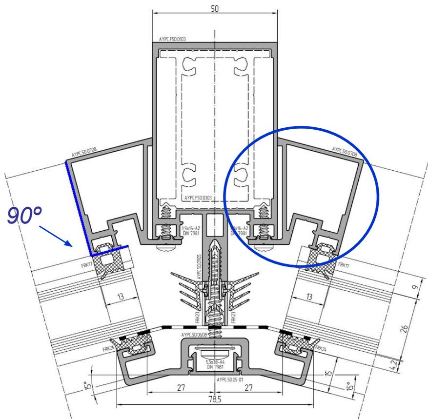
Излом фасада можно реализовать с помощью одной стойки и установленных на неё специальных камерных профилей-адаптеров (-15°, -30°, -45°)
