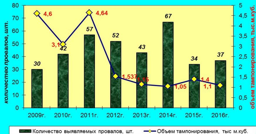
Активизация карстовых явлений вызвана, нарушением естественных условий в период эксплуатации газопроводов. В результате деформации поверхности (медленных просадок над подземными полостями) происходят аварии на газопроводах
