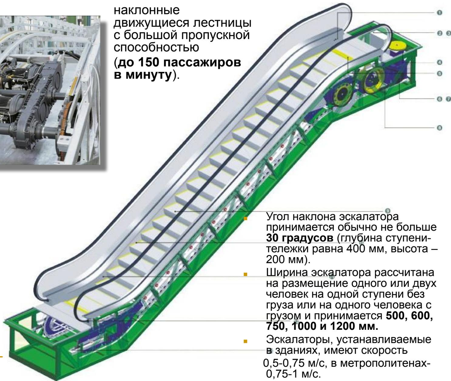
Угол наклона эскалатора
