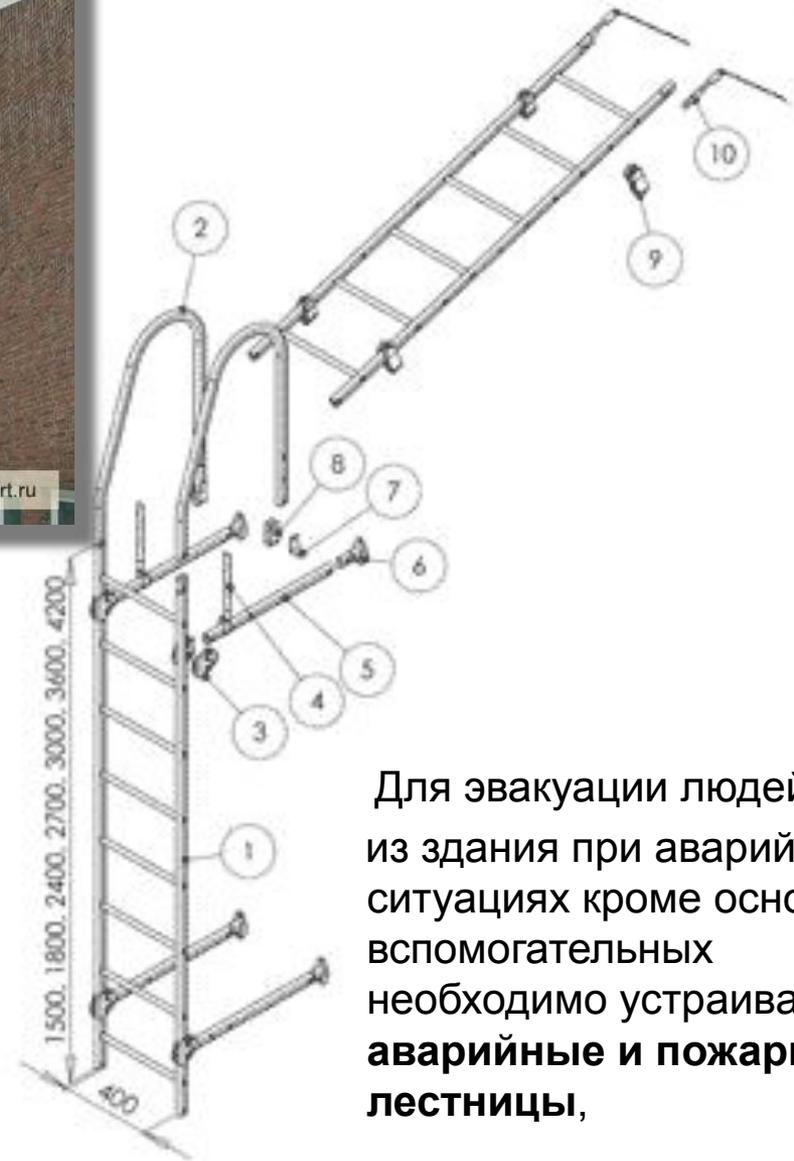
Для эвакуации людей из здания при аварийных ситуациях кроме основных и вспомогательных необходимо устраивать **аварийные и пожарные лестницы,**
