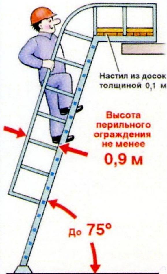
Навесные лестницы длиной более 5м вертикальные и устанавливаемые с углом наклона к горизонту более  $75^\circ$  должны иметь дуговое ограждение или канаты с ловителями для закрепления карабина предохранительного пояса.
