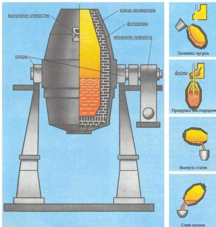
Принципиальная схема кислородного конвертера
