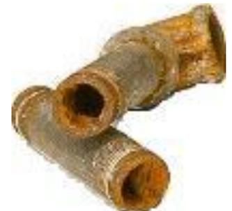
**Коррозия** – самопроизвольно протекающий процесс разрушения  $Me$  при химическом и электрохимическом взаимодействии с окружающей средой.
