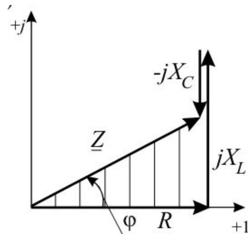
Анализ диаграммы сопротивлений позволяет перейти от алгебраической формы записи комплексного сопротивления к тригонометрической и показательной формам:
