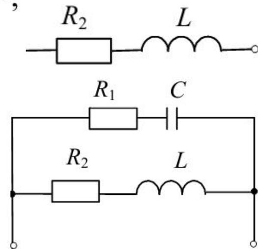
Если эти ветви включены параллельно друг другу, то полная комплексная проводимость такой цепи запишется как
