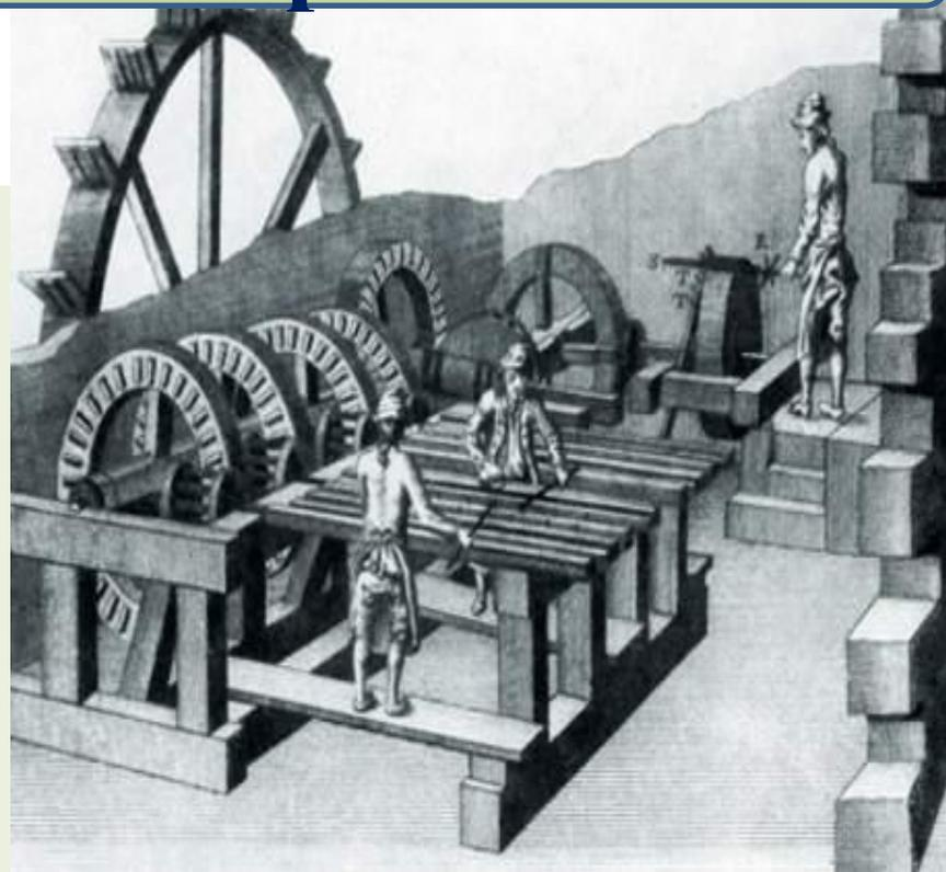
*Полировка каналов и наружных поверхностей стволов в оружейной мануфактуре XVIII века.*
