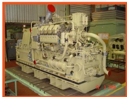
**ДГ-880, 882 8-цилиндровый дизельный генератор 880, 882 кВт**
