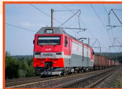
**2ЭС7 Электровоз переменного тока с асинхронным приводом**
