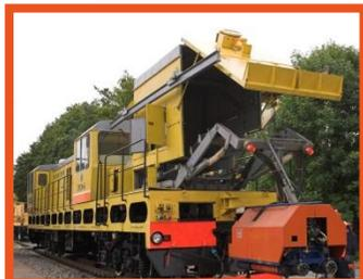
Путевая рельсварочная самоходная машина ПРСМ-6
