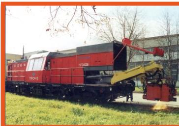
Путевая рельсварочная самоходная машина ПРСМ-5
