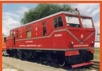
Автомотриса дефектоскопная электрическая АДЗ-1
