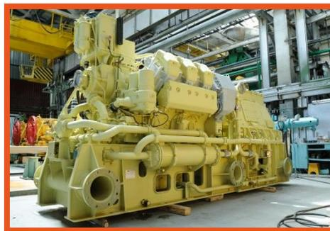
**ДГ - 630, АДГ-630 6-цилиндровый дизельный генератор 630 кВт**
