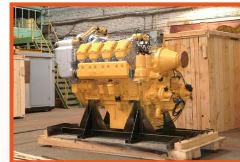
**8DM-21 8-цилиндровый дизельный двигатель 882 кВт**
