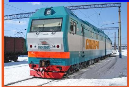
**2ЭС6 грузовой двухсекционный электровоз постоянного тока**
