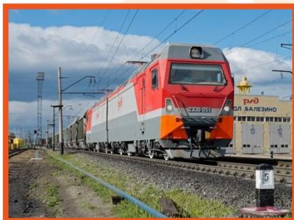
**2ЭС10 грузовой двухсекционный электровоз постоянного тока**
