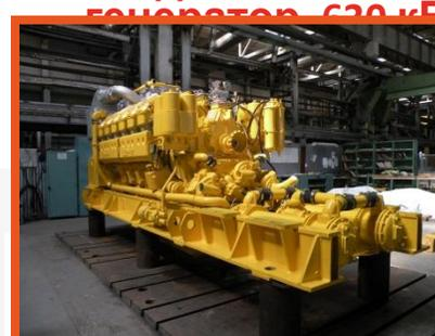
**12 ДМ-21 12-цил. двигатель и ДГ ДГ-1400, АДГ-1600, 1400, 1600 кВт**
