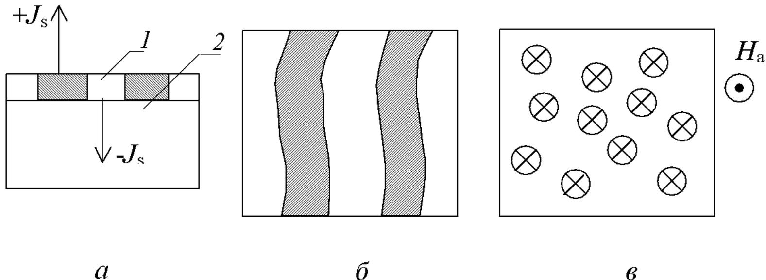
Рис. 3.27. Магнитные домены в монокристаллических пленках: *a* - структура монокристаллической пленки (поперечный разрез); *б* - полосовые магнитные домены (вид сверху); *в* - возникновение цилиндрических магнитных доменов под влиянием внешнего магнитного поля  $H$
