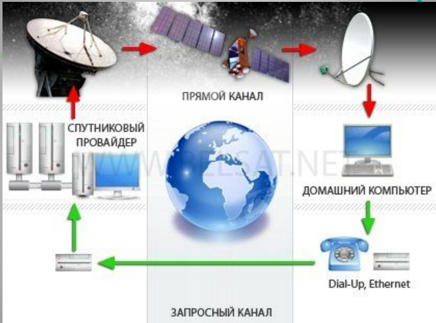
Подключение по спутниковому каналу
