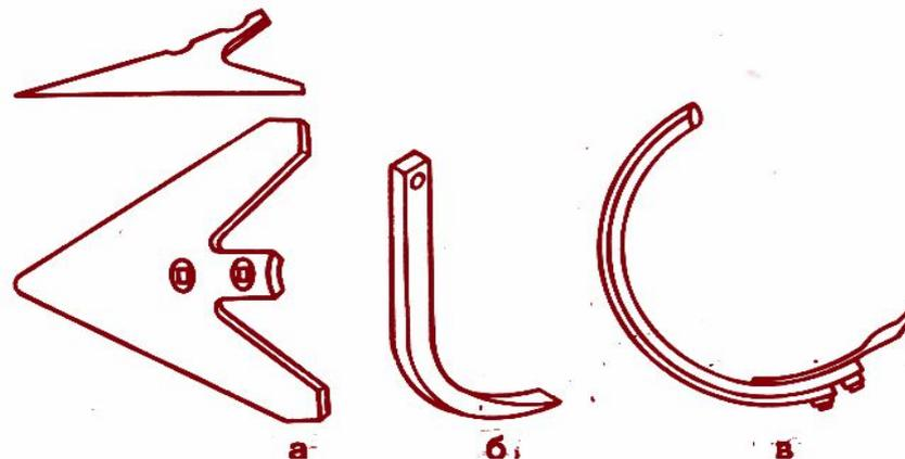
Рабочие органы для сплошной обработки почвы:
