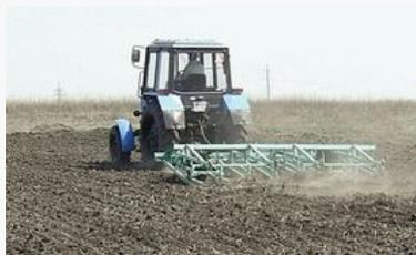
Культиватор КПС-4 может оснащаться как стрельчатыми лапами, так и пружинными зубьями .
