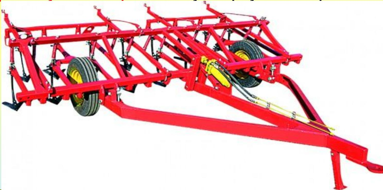
**Пропашные культиваторы** применяют при уходе за пропашными культурами, т.е. проводят междурядную обработку.
