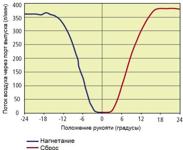
Регулировка номинального уровня подвески производится установкой длины тяги, соединенной с рукоятью. Чем больше длина – тем при более высоком уровне подвески рукоять клапана установится в горизонтальное положение.
