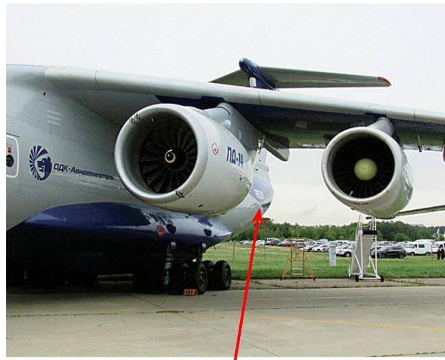
Рисунок 15. Испытываемый опытный ТРДД ПД-14 на ЛЛ ИЛ-76
