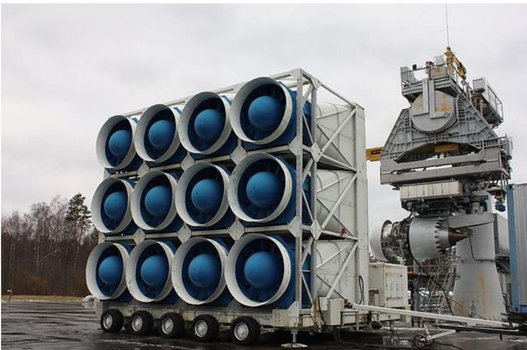
Рисунок 11. Стендовое устройство воздуходувок на открытом стенде в Полуево (г. Рыбинск) для исследования влияния бокового задува воздуха на вход в ТРДД ПД-14 для проверки уровня предельного возмущения потока  $W = \Delta\sigma_0 + \varepsilon$  на входе в вентилятор и оценки устойчивости компрессоров.
