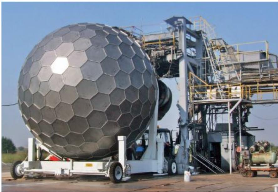
Рисунок 13. Подготовка ПД-14 к проведению исследований акустических характеристик.
