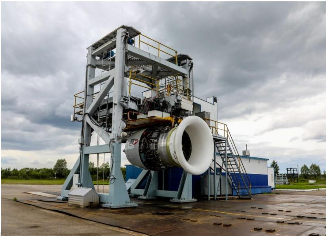
Рисунок 10. Открытый стенд ОС-5 АО «ОДК-Авиадвигатель» для проверки основных данных и акустических характеристик ТРДД. (Изменение высоты осевой линии от земли 2...6,9 м).
