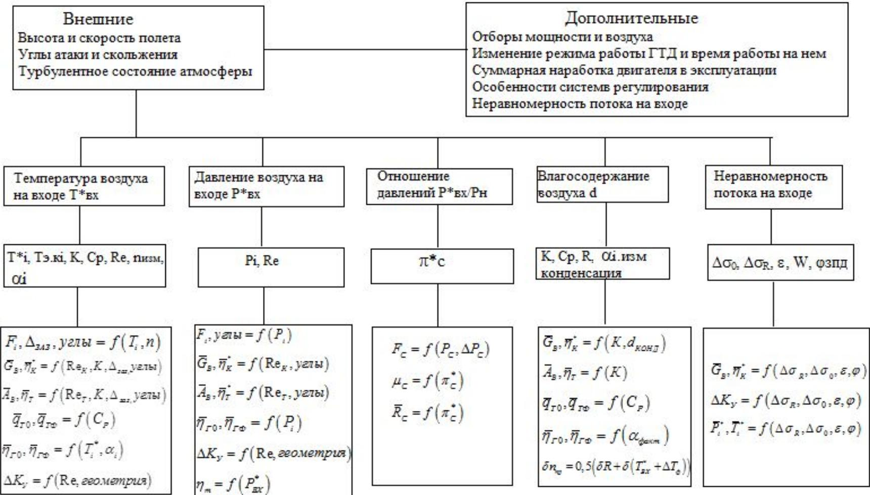
Внешними эксплуатационными факторами для ГТД являются высота «Н» и скорость полета (число Маха «Мп»), углы атаки « $\alpha$ » и скольжения « $\beta$ » летательного аппарата, а также влажность и турбулентность атмосферного воздуха.
