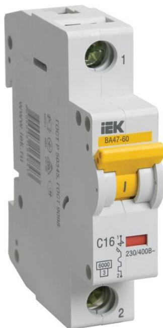
ГОСТ Р 51778-2001 требует, чтобы отключающая способность защитных аппаратов, устанавливаемых на вводах щитков, была не менее 6 кА на номинальные токи до 63 А и 10 кА - на номинальные токи до 125 А.
