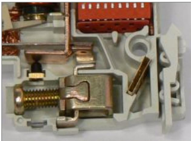
Защита механизма теплового расцепителя
