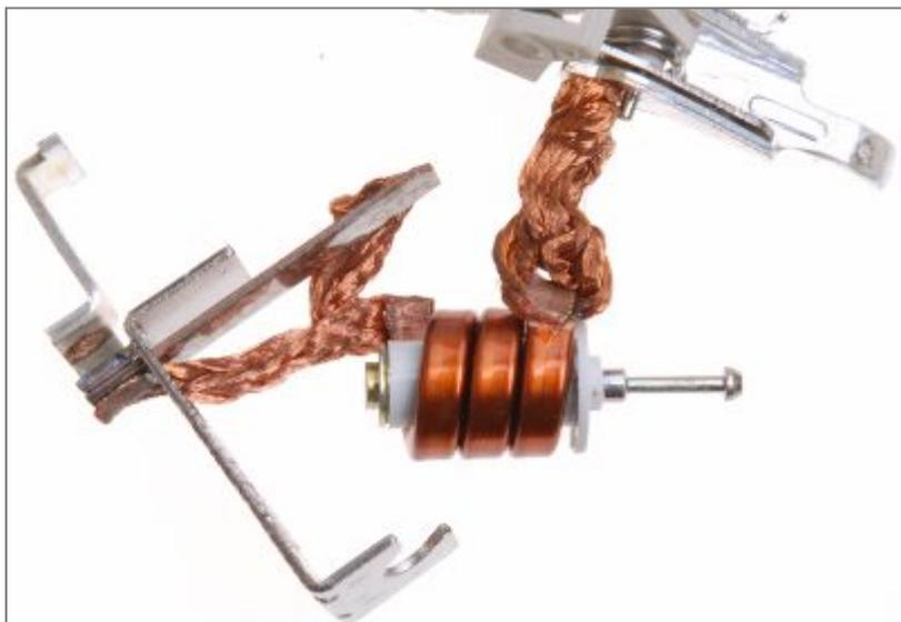
Наплавка из серебросодержащего композита повышает износостойкость контактной группы и снижает переходное сопротивление
