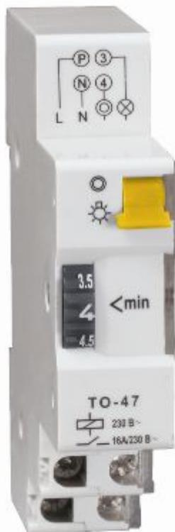
Таймеры освещения предназначены для автоматического включения и отключения освещения лестничной площадки, коридора или другого объекта в течение заданного диапазона времени (от 1 до 7 мин).
