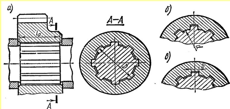
Зубчатые соединения различают: по характеру соединения: **неподвижные** — для закрепления детали на валу (см. рис); **подвижные** — допускающие перемещение детали вдоль вала (например, блока шестерен коробки передач станка); по форме зубьев: **прямобоковые** (см. рис.), эвольвентные; треугольные; по способу центрирования ступицы относительно вала: **с центрированием по наружному диаметру  $D$**  (рис. а), **по внутреннему диаметру  $d$**  (рис. б) и **по боковым поверхностям зубьев** (рис. в).
