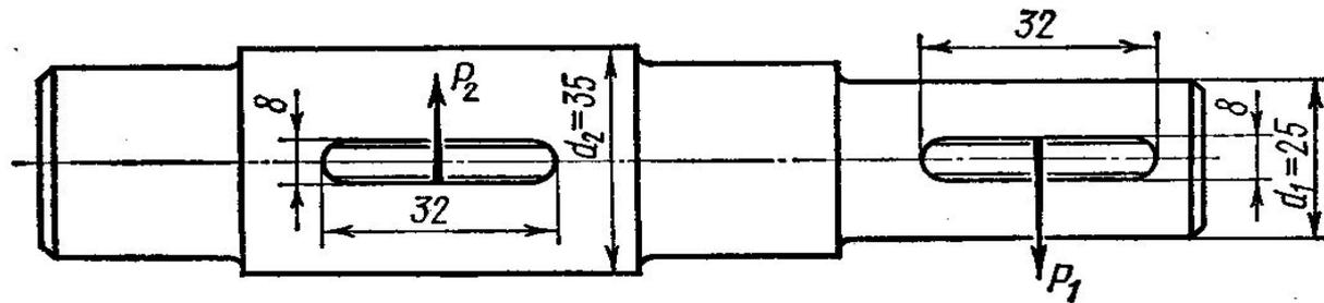
1. Перепад диаметров ступеней вала с призматическими шпонками назначают из условия свободного прохода детали без удаления шпонок из пазов.
