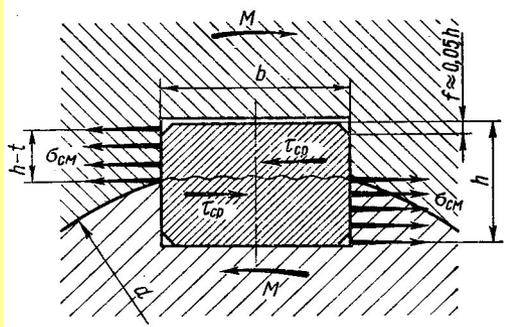
Основным критерием работоспособности шпоночных соединений является прочность. Шпонки выбирают по таблицам ГОСТов в зависимости от диаметра вала, а затем соединения проверяют на прочность. Размеры шпонок и пазов в ГОСТах подобраны из условия прочности на смятие, поэтому основным проверочным расчетом шпоночных соединений является расчет на смятие.
