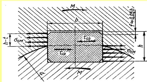
Соединения сегментными шпонками проверяют на смятие:
