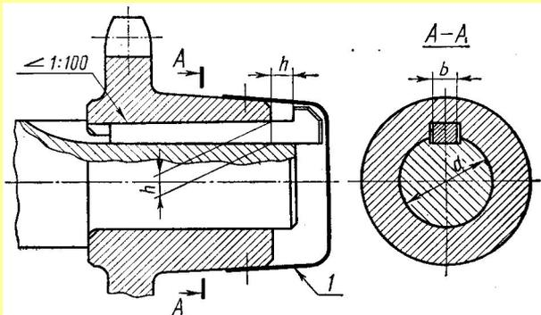
Клиновые шпонки имеют форму односкосных самотормозящих клиньев с уклоном 1:100. Такой же уклон имеют пазы в ступицах. Клиновые шпонки без головок изготавливают по ГОСТ 8792 — 68. Шпонки с головками выполняют по ГОСТ 8793 — 68. Головка служит для выбивания шпонки.
