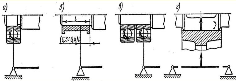
Проверочный расчет валов производится на усталостную и статическую прочность и на жесткость, а в отдельных случаях на колебания. Выполняется после конструктивного оформления вала на основе проектного расчета и подбора подшипников. Расчет вала выполняют по его расчетной схеме.
