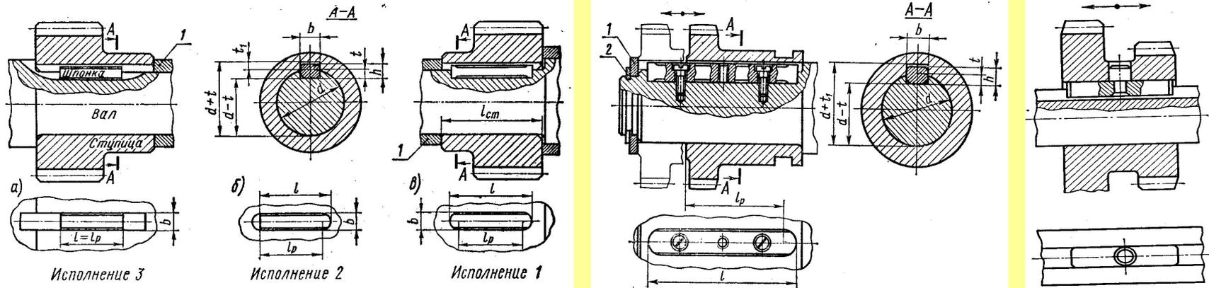
Конструкции соединений призматическими шпонками изображены на рис. Рабочими являются боковые, более узкие грани шпонок высотой  $h$ . Размеры сечений шпонок и пазов принимают в зависимости от диаметра вала  $d$  по ГОСТ 8788 — 68. По форме торцов различают шпонки со скругленными торцами — исполнение 1 (рис. 1 в), с плоскими торцами — исполнение 3 (рис. 1 а) и с одним плоским, а другим скругленным торцом — исполнение 2 (рис. 1 б). Шпонки исполнения 1 рекомендуются для более точных соединений.
