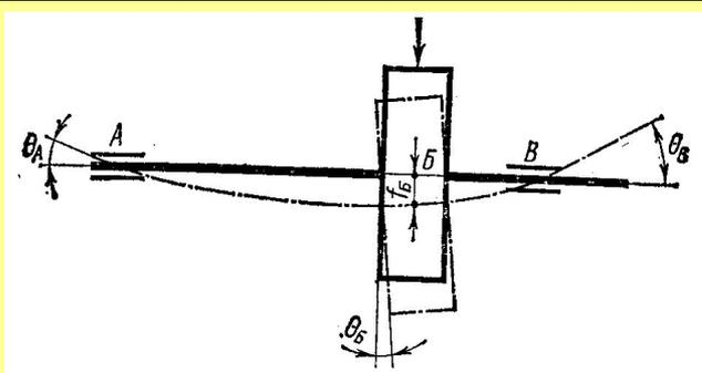
Проверочный расчет валов на жесткость выполняется в тех случаях, когда их деформации существенно влияют на работу сопряженных с валом деталей.
