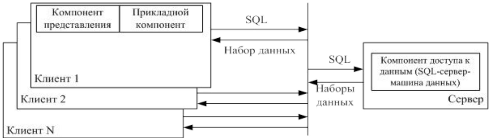
**Рис 5.4. Модель удаленного доступа к данным (RDA-модель)**
