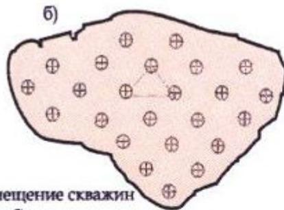
Равномерное размещение скважин
