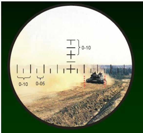
**Измерение углов полевым биноклем.**
