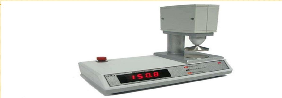
Прибор для определения индекса деформации клейковины
