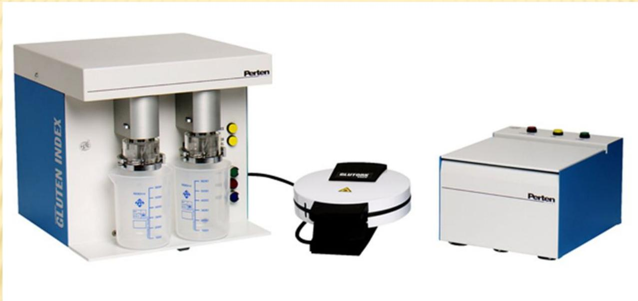
Система Glutomatic 2200 состоит из прибора для замеса теста и отмывания клейковины, центрифуги и прибора для определения содержания сухой клейковины Glutork 2020.
