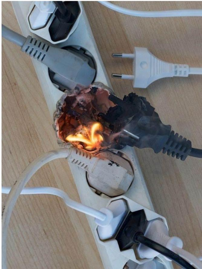
Короткое замыкание – это электрическое соединение разных фаз или потенциалов электроустановки между собой или с землей, не предусмотренное в нормальном режиме работы, при котором в проводниках, в месте контакта, резко возрастает сила тока.
