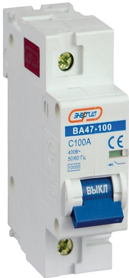
Автоматические выключатели – это устройства, которые предназначены для защитного отключения цепей постоянного и переменного тока в случаях короткого замыкания, токовой перегрузки, снижения напряжения или его исчезновения. В отличие от плавких предохранителей автоматические выключатели имеют более точный ток отключения, могут многократно использоваться.
