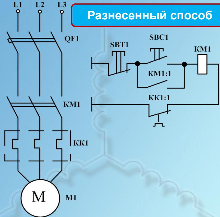
**Не реверсивная принципиальная схема управления асинхронным двигателем с помощью магнитного пускателя**
