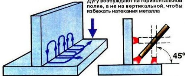
Угловые швы без скоса кромок с катетами более 10 мм выполняют в один слой поперечными движениями электрода треугольником с задержкой в корне шва
