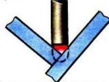
При наложении угловых швов наклонным электродом (в т.ч. "в лодочку") сварку лучше вести углом назад
