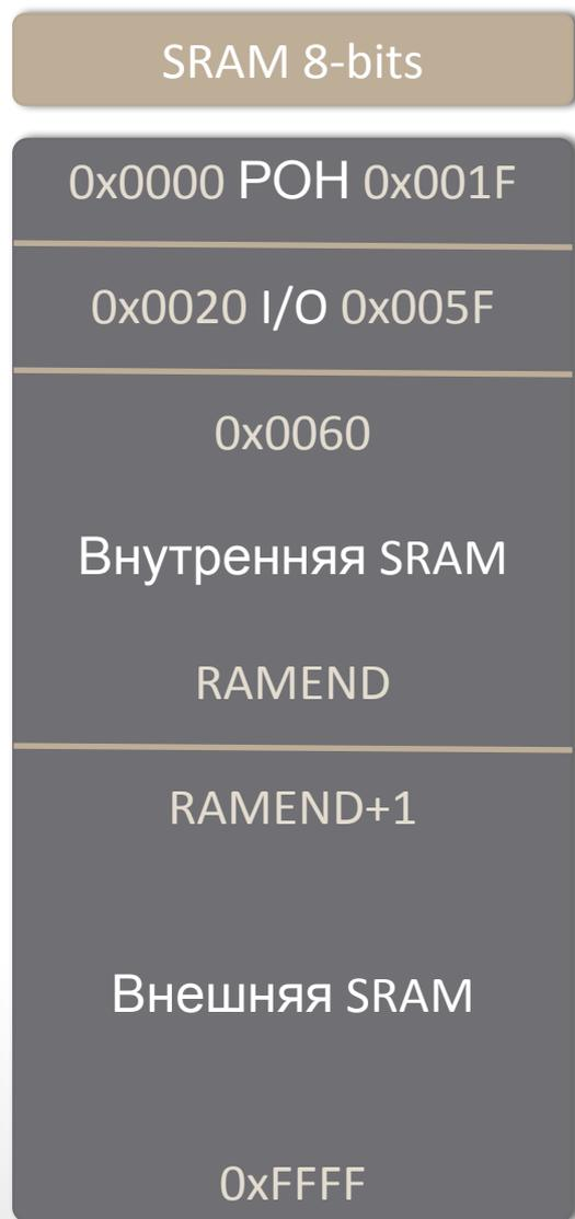
**SP** (Stack Pointer) – указатель стека, указывает на начало стека. Стек растет в верх, указатель стека вниз. При добавлении элемента указатель стека уменьшается
