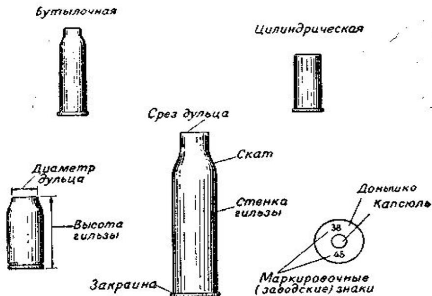
**Закраина** (выступающая закраина фланец, рант, шляпка) — кольцевой выступ у основания гильзы или нижняя часть гильзы, образованная кольцевой проточкой (например, в большинстве современных патронов к автоматическому оружию). Служит для извлечения (экстрагирования) гильзы из патронника.
