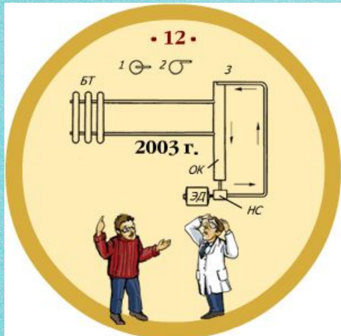
окружности, образующей стенку цилиндрической колонки. При подключении по способу 1 количество тепла, отдаваемое воде, равно (с учетом потерь) количеству тепла, излучаемому батареей (БТ) в окружающее пространство. Но как только происходит подключение трубы по способу 2, количество излучаемого батареей (БТ) тепла увеличивается в
