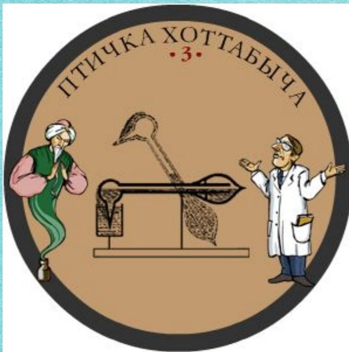
При испарении воды температура головы птички снижается. В нижнюю часть туловища птички налит эфир, над которым находятся пары эфира (воздух откачен). При охлаждении головы птички давление паров в верхней части снижается. Но давление в нижней части остается тем же. Избыточное давление паров эфира в нижней части поднимает жидкий эфир по трубочке вверх, голова птички тяжелеет и наклоняется к стакану.
