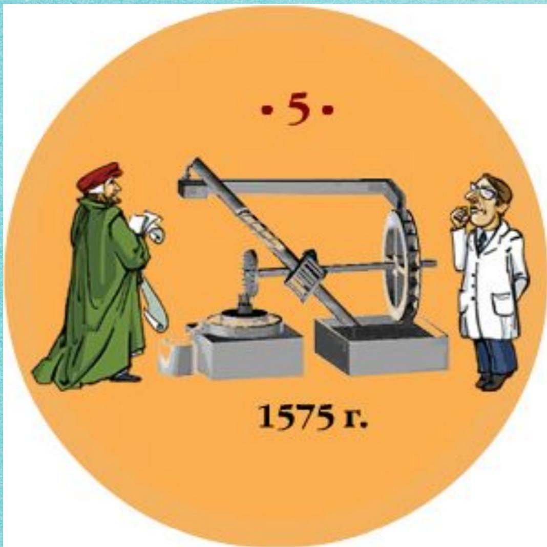
**Идея изобретателя:** Архимедов винт, вращаясь, поднимает воду в верхний бак, откуда она вытекает из лотка струей, попадающей на лопатки водяного колеса. Водяное колесо вращает точильный камень и одновременно двигает, с помощью ряда зубчатых колес, тот самый Архимедов винт, который поднимает воду в верхний бак. Винт поворачивает колесо, а колесо — винт! Этот проект, изобретенный еще в 1575 году итальянским механиком Страдою Старшим, затем повторялся в многочисленных вариациях.
