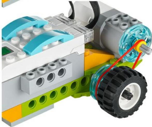
*3. Третий фактор влияющий на скорость – это редукция, передача движения с большего колеса на меньшее. Работает это просто – одно колесо делает один оборот, а второе (меньшее) делает на несколько оборотов больше. Таким образом можно передавать движение от двигателя увеличив частоту (скорость) вращения. Данным способом, с помощью редуктора (коробка передач) инженеры-конструкторы могут увеличивать или скорость, или мощность.*
