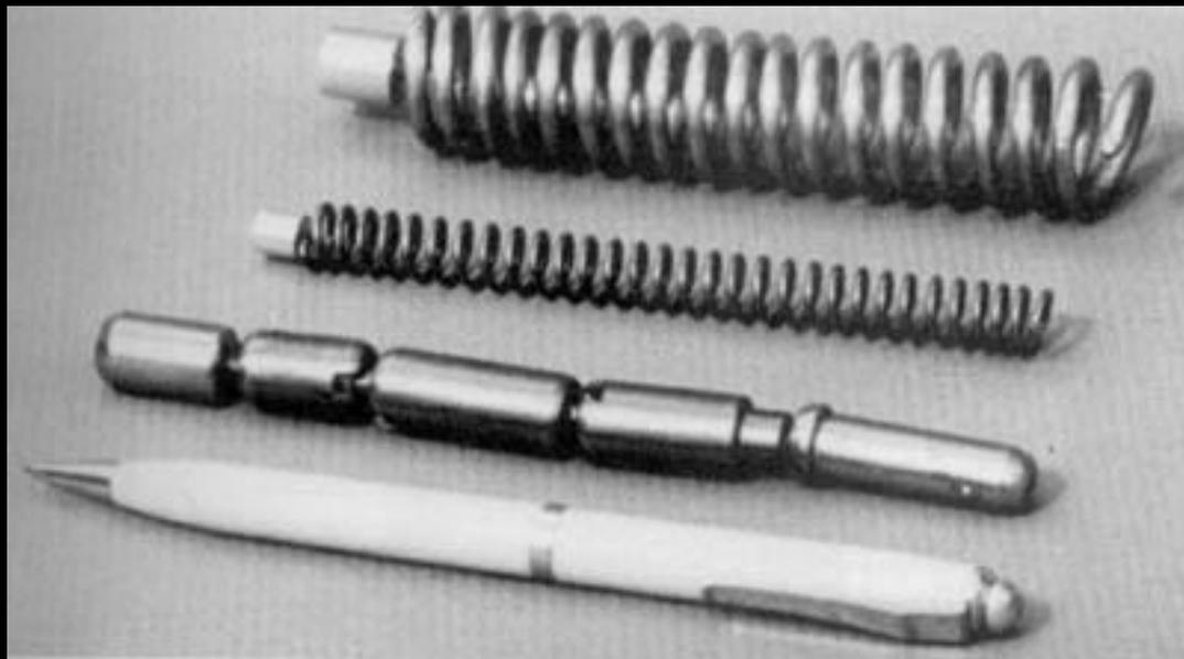
**Источник гамма-излучения (ирридий-192) из дефектоскопа с ампулодержателем**
