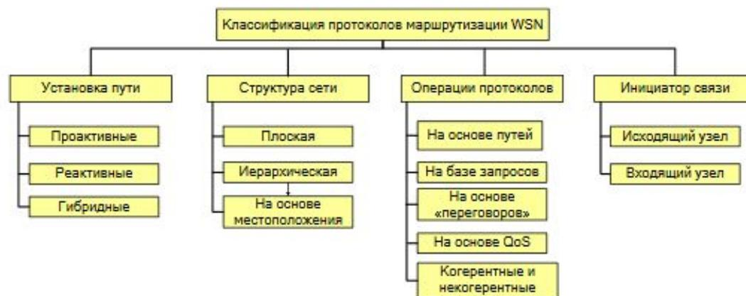
Рис. 3.10 – Классификация протоколов маршрутизации БСС
