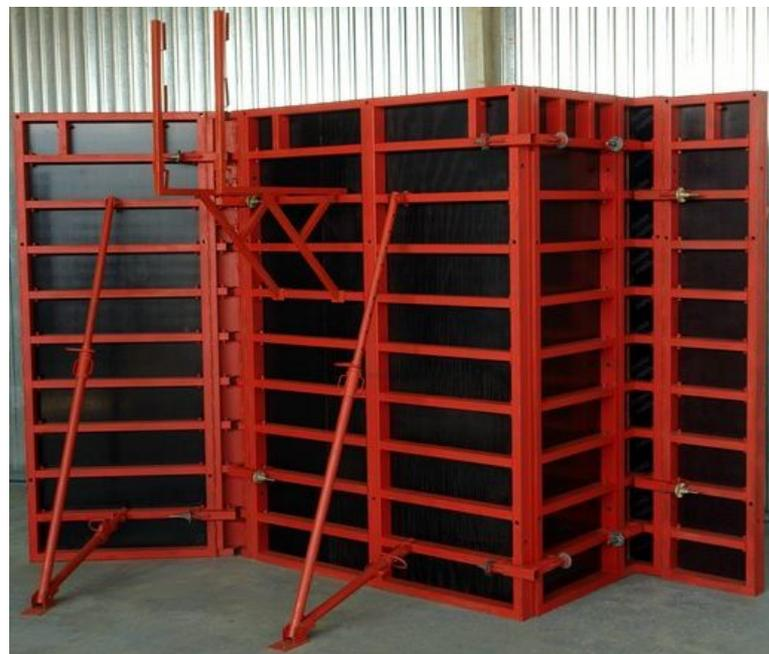
Для обеспечения устойчивости опалубки и выверки ее в проектное положение используют различные системы подкосов и раскосов, снабженные механическими винтовыми домкратами и регулировочными устройствами.
