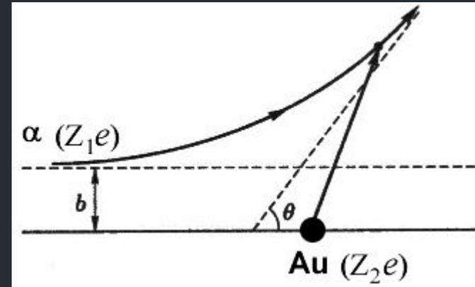
Рассеяние  $\alpha$ -частицы на атомном ядре (Au).
