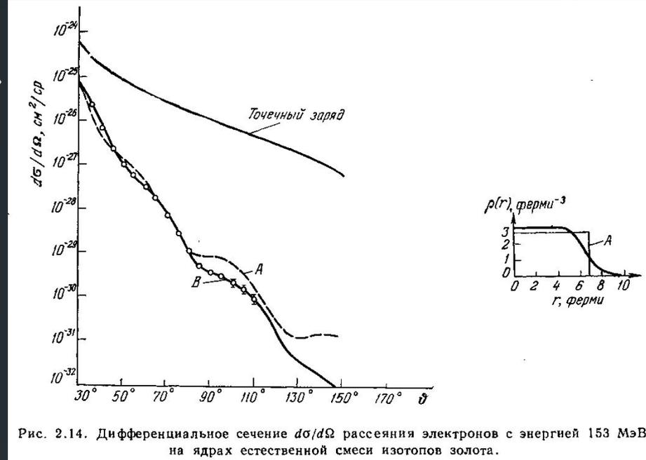
Рис. 2.14. Дифференциальное сечение  $d\sigma/d\Omega$  рассеяния электронов с энергией 153 МэВ на ядрах естественной смеси изотопов золота.
