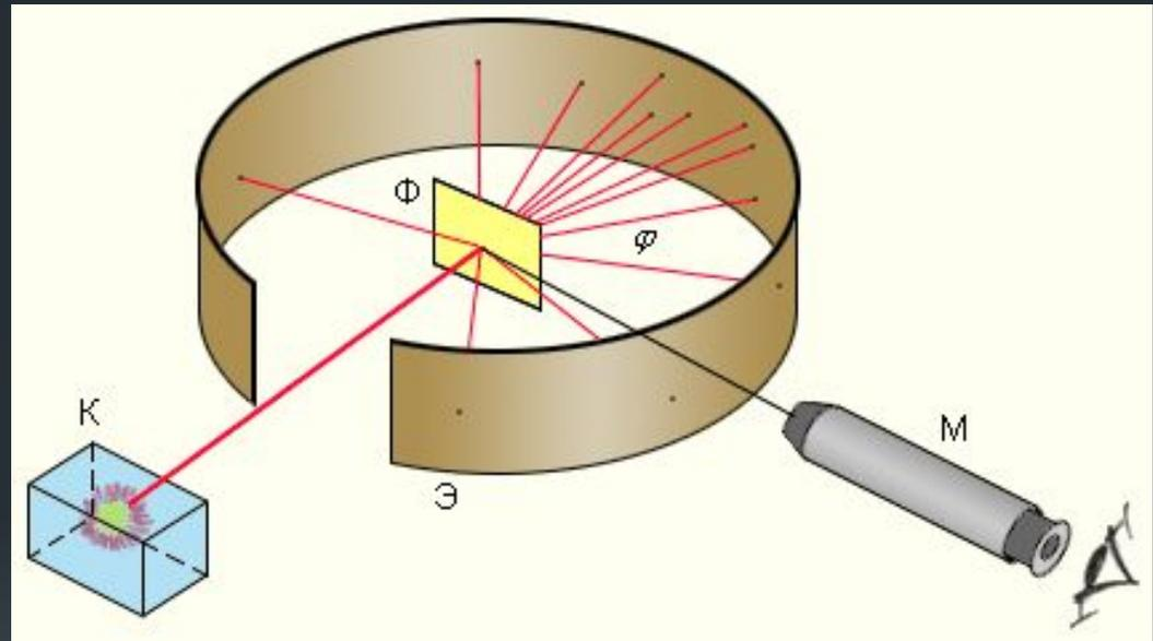
Схема опыта Резерфорда по рассеянию α-частиц.
