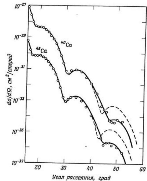
Фиг. 6.5. Зависимость дифференциального эффективного сечения рассеяния пучка электронов с энергией 750 МэВ на ядрах изотопов Ca от угла рассеяния [9]. Эффективное сечение для  $^{40}\text{Ca}$  увеличено в 10 раз, а для  $^{48}\text{Ca}$  уменьшено в 10 раз.
