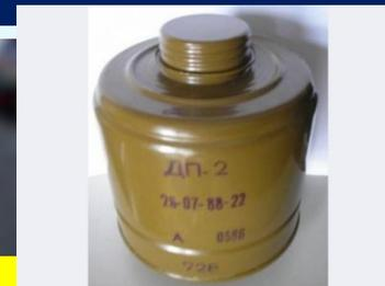
**Гопкалитовый патрон - дополнительный патрон к противогазам для защиты от оксида углерода. Основным химическим реагентом, обеспечивающим работу гопкалитового патрона, является смесь оксидов марганца и меди (60%  $MnO_2$  и 40%  $CuO$ ), получившая название —гопкалит.**
