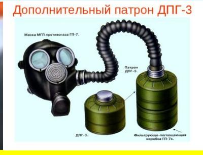
Противоголоз ГП-7, а также детские противоголозы ПДФ-Д, ПДФ-Ш, ПДФ-2Д, ПДФ-2Ш защищают от таких АОВ, как хлор, сероводород, сернистый газ, соляная кислота, синильная кислота, тетраэтилсвинец, этилмеркаптан, нитробензол, фенол, фурфурол, фосген.
