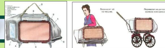
предназначена для защиты детей в возрасте до 1,5 года от ОВ, РВ и БС в интервале температур от  $+30^{\circ}\text{C}$  до  $-30^{\circ}\text{C}$ . В комплект входят: камера защитная детская КЗД-6, накидка для защиты от атмосферных осадков, картонная коробка и полиэтиленовый мешок для хранения камеры.
