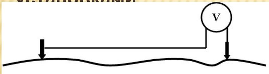
Электроразведочная установка для измерения естественного электрического поля
