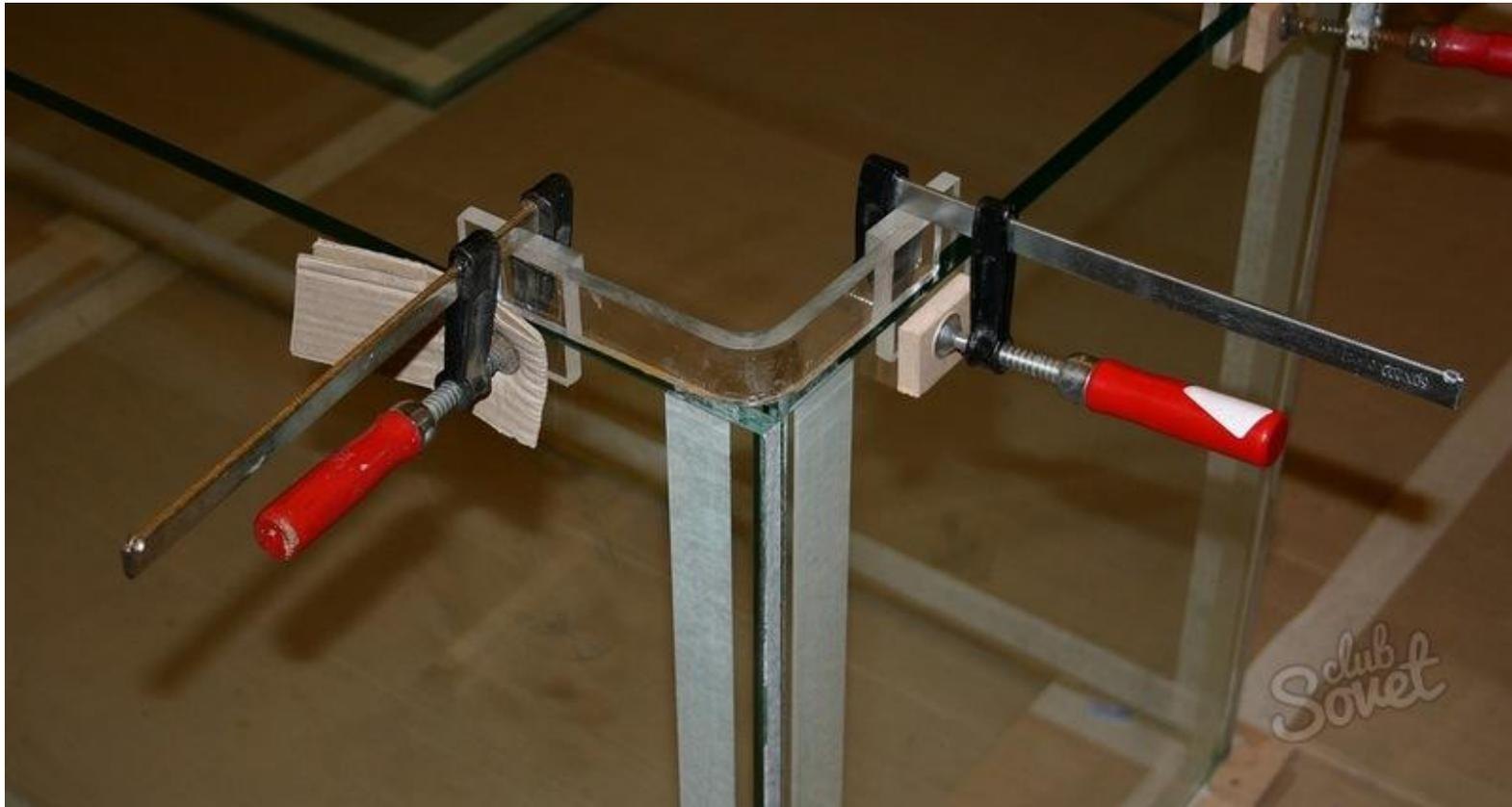
*Отверждение клея* происходит при определенном температурном режиме и давлении.
