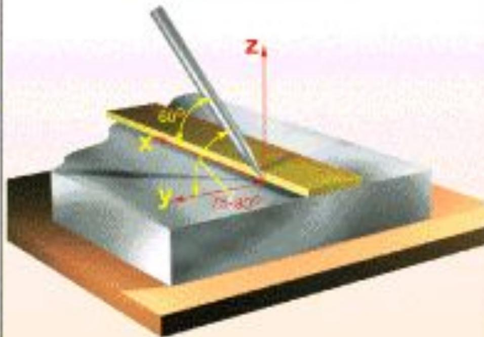
Прямые риски наносят чертилкой, которая должна быть наклонена по направлению ее перемещения и в сторону от линейки. Углы наклона должны соответствовать указанным на рисунке и не изменяться в процессе нанесения рисок, иначе риски не будут параллельны линейке. Чертилку все время прижимают к линейке, которая должна плотно прилегать к детали.
