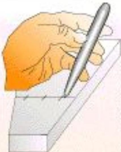
Центры кернов должны располагаться точно на разметочных линиях, чтобы после обработки детали оставались половины кернов.
