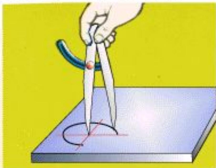
Циркули используют для разметки окружностей и дуг, деления отрезков и окружностей, а также для геометрических построений. Циркулями пользуются и для переноса размеров с измерительных линеек на деталь.
