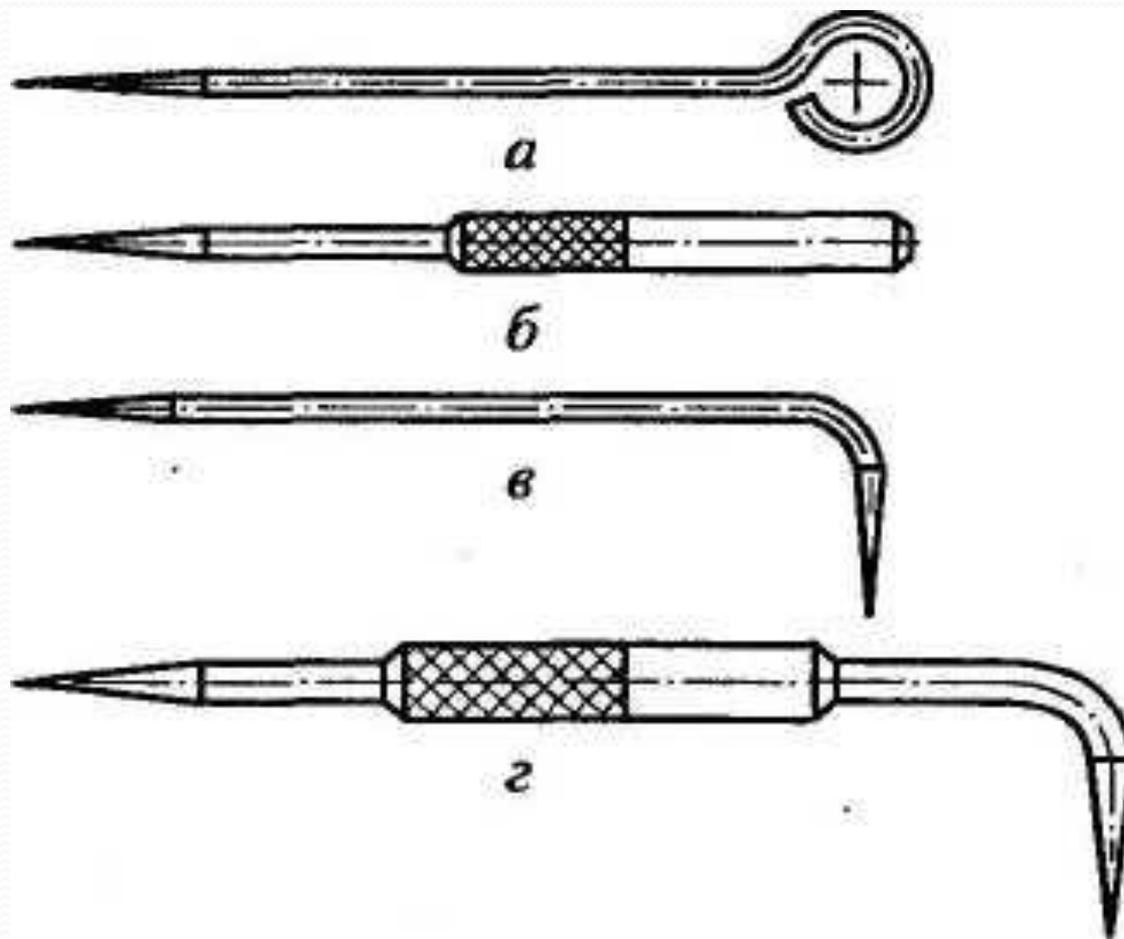
**Чертилки** являются наиболее простым инструментом для нанесения контура детали на поверхность заготовки и представляют собой стержень с заостренным концом рабочей части.
