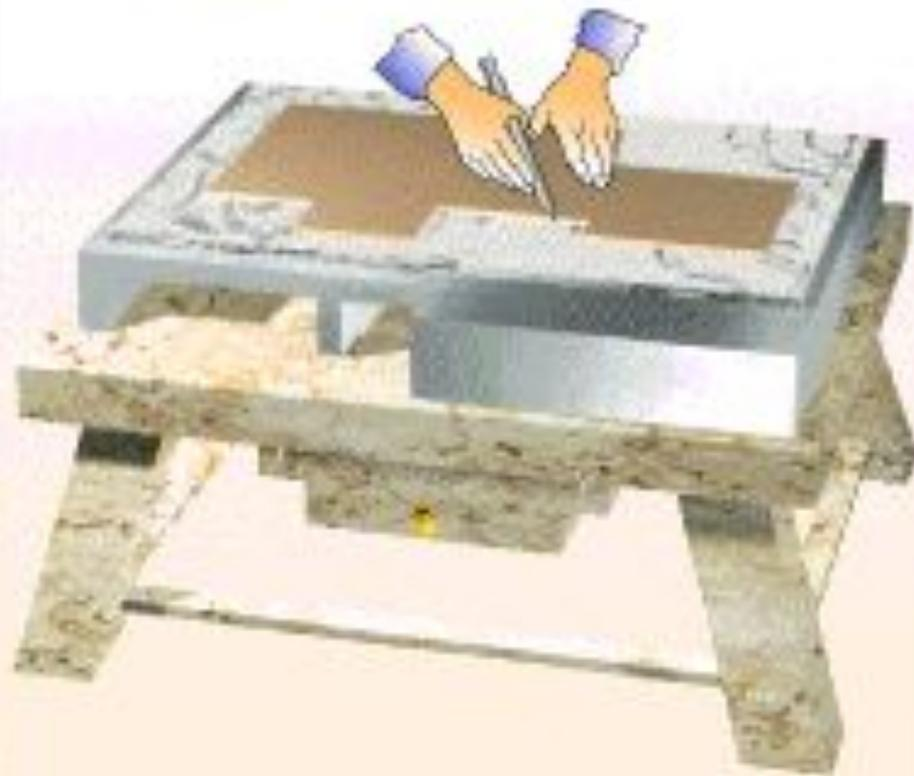
При разметке шаблон накладывают на окрашенную заготовку (деталь) и проводят чертилкой риску вдоль контура шаблона, после чего риску накармливают. Иногда шаблон служит кондуктором, по которому, по которому деталь обрабатывают без разметки.
