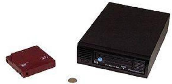
Этот носитель часто используется для создания резервных копий пространства жесткого диска или для хранения очень больших наборов данных.
