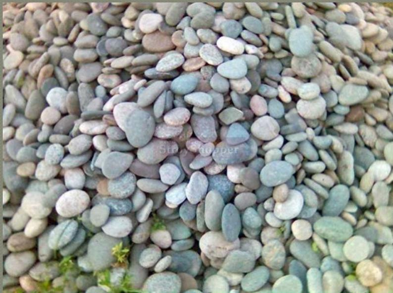
**Гравий** – окатанные водой обломки диаметром 2-10мм. Используется в качестве заполнителя бетона и в дорожном строительстве.
