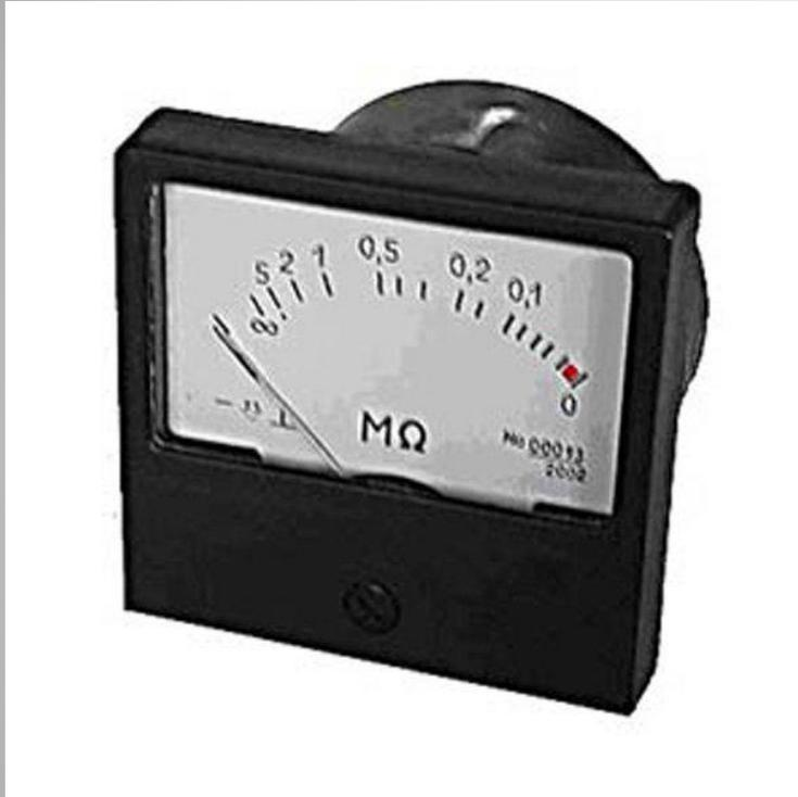
Простейший омметр представляет собой преобразователь, ток через который создается источником постоянного во времени напряжения и зависит от значения измеряемого сопротивления  $R_X$ . Указанное сопротивление может быть включено последовательно или параллельно измерительному преобразователю. Шкала прибора может быть при этом проградуирована в единицах сопротивления.
