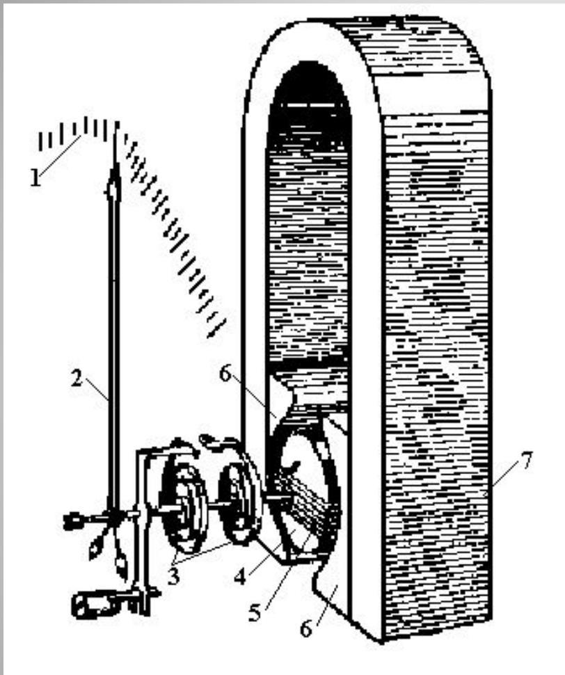
Конструкция магнитоэлектрического преобразователя
