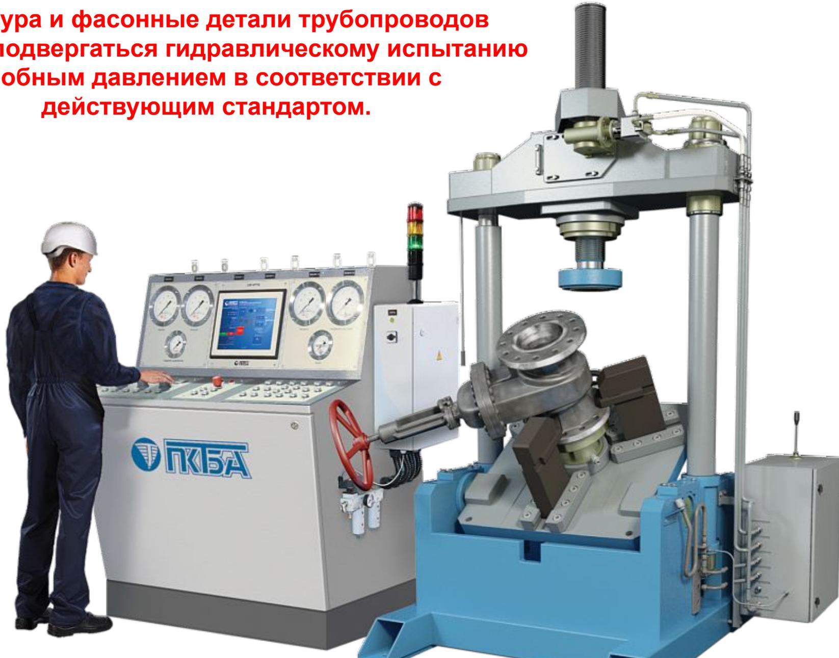
**Минимальная величина пробного давления при гидравлическом испытании должна составлять 1,25 рабочего давления, но не менее 0,2 МПа (2 кгс/см<sup>2</sup>)**
