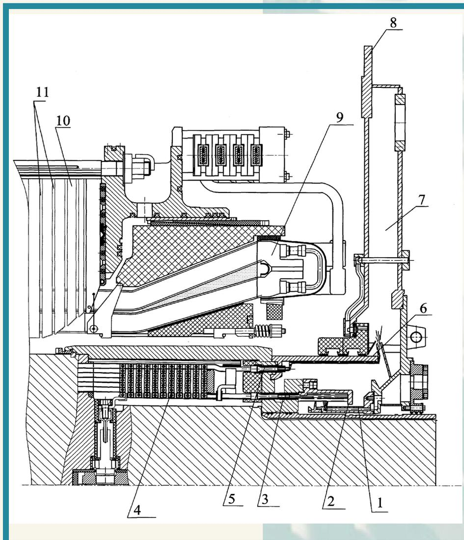
1 – неподвижный напорный коллектор; 2 – напорное кольцо; 3 – нижние выводы обмотки ротора; 4 – обмотка ротора; 5 – верхние выводы обмотки ротора; 6 – сливное кольцо; 7 – неподвижная камера слива; 8 – торцевой щит корпуса статора; 9 – лобовые части обмотки статора; 10 – сердечник; 11 – охладитель сердечника
