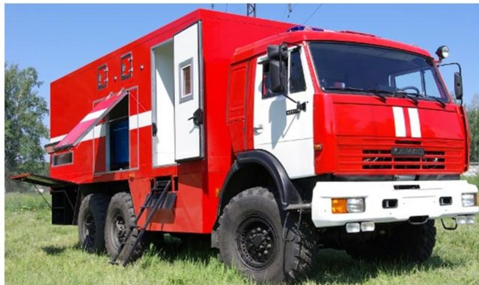
**ПКС 2000-300** предназначена для обеспечения быстрой заправки баллонов дыхательных аппаратов с рабочим давлением до 300бар. Для пожарной охраны при тушении крупных пожаров в населенных пунктах и на промышленных объектах.
