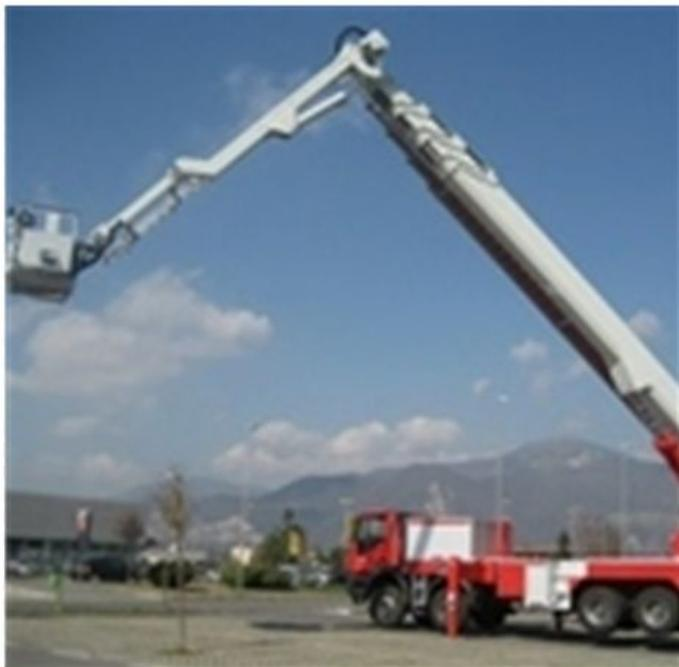
Пожарный телескопический автоподъемник с пенобаком, насосом и боковой лестницей
