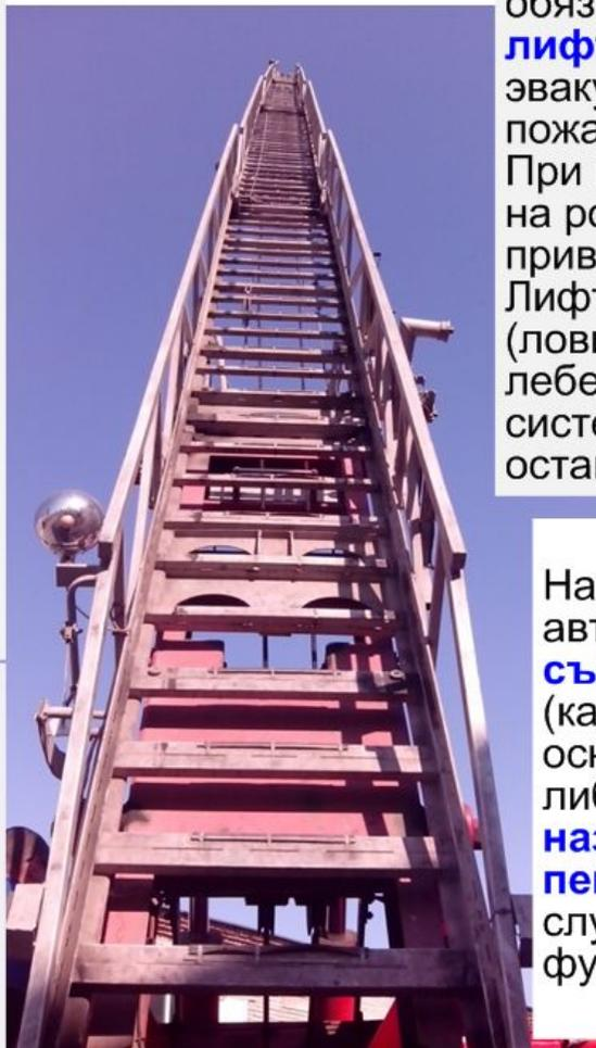
Комплекты колен высотных автолестниц в обязательном порядке оснащаются **лифтом**, который служит для быстрой эвакуации людей или подъёма на высоту пожарных и специального оборудования. При помощи лебедки лифт перемещается на роликах по направляющим, приваренным к верхним поясам колен. Лифт снабжен системой торможения (ловителем). В случае обрыва троса лебедки автоматически срабатывает система торможения, и лифт останавливается.
