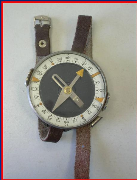
Имеет две шкалы. С градусными делениями от  $0^{\circ}$  до  $360^{\circ}$  возрастающими по ходу часовой стрелки и шкалой тысячных (угломерная) отсчитываемых через 500 тысячных в обратном направлении.
