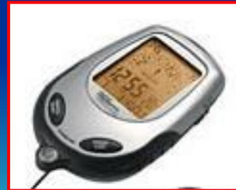
**ПРИНЦИП РАБОТЫ** большинства электронных компасов основан на датчиках, называемых магнитометрами.
