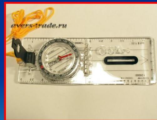
**Традиционный стрелочный компас** – это тонкая легкая намагниченная стрелка, установленная свободно в своей средней точке на вертикальной оси (игле), которая позволяет ей поворачиваться в горизонтальной плоскости.
