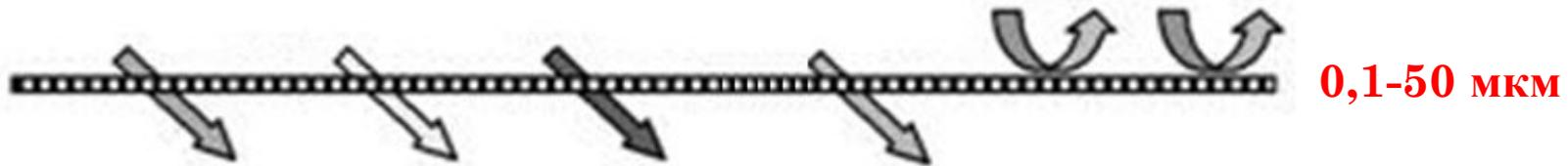
**Ультрафильтрация** P=2-3 атм
