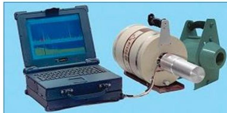
Мобильный спектрометрический комплекс СКС-50М
