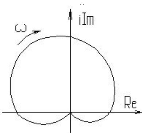
Рис. 23 Вид АФЧХ системы со скоростной связью
