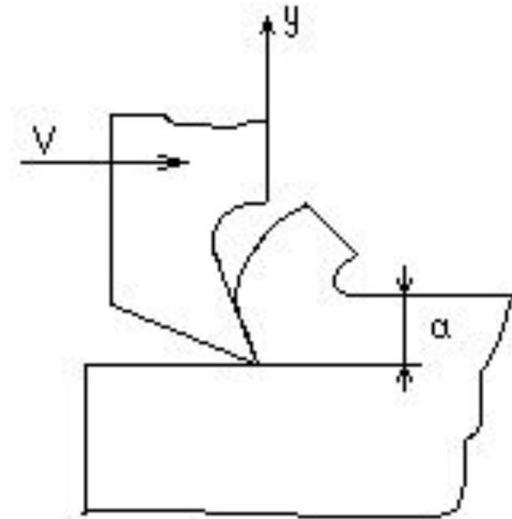
Рис.3 Колебания по нормали к поверхности резания в переходном процессе при врезании резца
