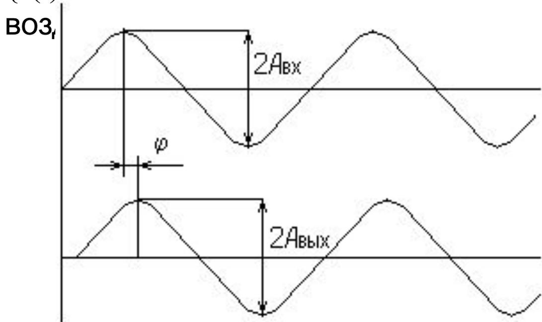
Рис. 5 Входной и выходной синусоидальные сигналы
