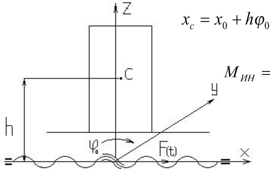
Рис. 22 Простейшая динамическая система с инерционной связью
