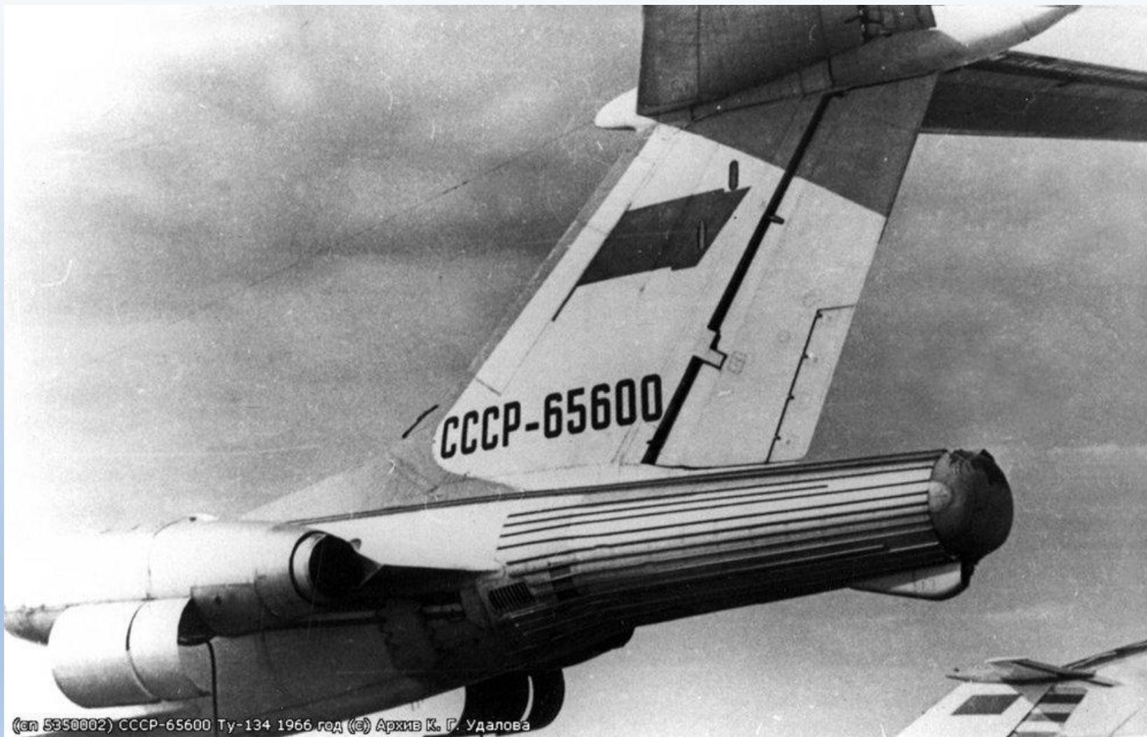
Опытный ТУ-134 с противостопорным парашютом
