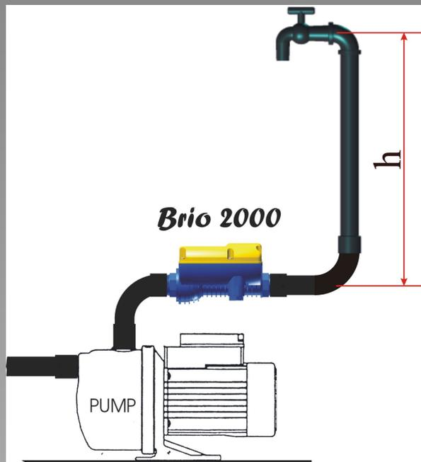
Стартовое давление должно быть настроено в соответствии с высотой водяного столба на выходе из Vrio. Каждый 1 метр водяного столба соответствует 0.1 бара. Заводская настройка 1.5 бара позволяет использовать Vrio при высоте водяного столба до 15 м.
