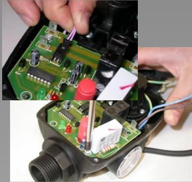
Отсоедините разъем от реле давления и удалите электронную плату, открутив крепежные болты.
