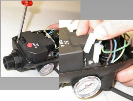
Установите заново защитную крышку платы и кнопку RESET. Подсоедините электрические кабели и закройте крышку корпуса устройства.
