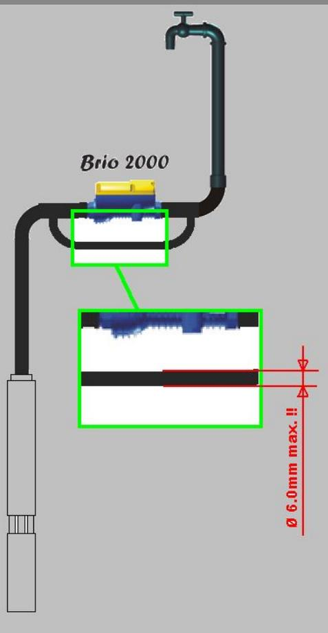
Когда Brio работает в системе с глубинным насосом, а обратный клапан, встроенный в насос, протекает и не закрывается плотно, велика вероятность, что труба между насосом и Brio опустошится в период длительного простоя (например, в ночное время суток).
