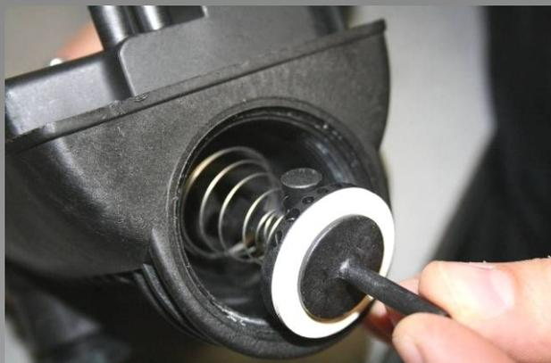
Если удалить уплотнение клапана, то можно в достаточной мере осмотреть обратный клапан. Входной штуцер можно открутить. При этом с особой осторожностью следует отнестись к пластиковым частям Vrio.
