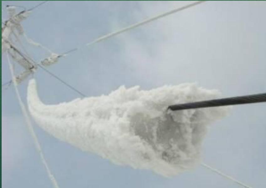
Гололедные и гололедно-ветровые нагрузки учитываются при проектировании и эксплуатации линий электропередачи и линий связи, а также различных ажурных сооружений. Выделяют **гололедную нагрузку** (массу отложения), **ветровую нагрузку при гололеде** и **гололедно-ветровую** (результатирующую) нагрузку.
