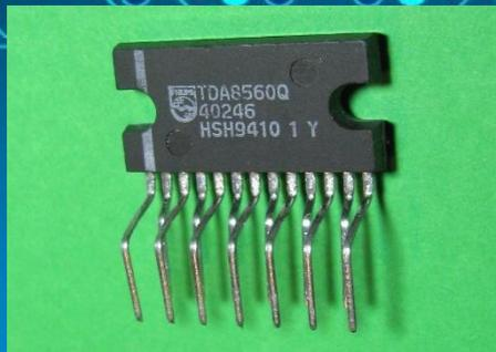
Интегральная микросхема TDA8560Q производства фирмы Philips Semiconductors представляет собой мостовой двухканальный УМЗЧ с однополярным питанием, способный развивать в каждом канале выходную мощность до 40 Вт на нагрузке сопротивлением 2 Ом. При напряжении питания 14,4 В с нагрузкой сопротивлением 4 Ом коэффициент гармоник — около 0,5 % при выходной мощности 19 Вт или 10% при 25 Вт в каждом канале.
